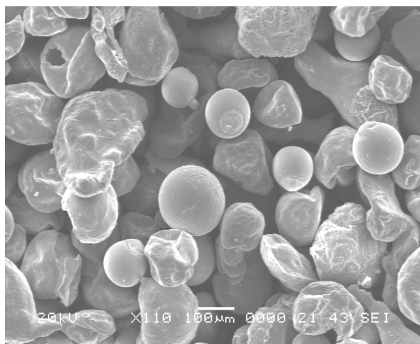
Fig. 1.22 Imagine SEM a pulberii Cu-Ni-Al
