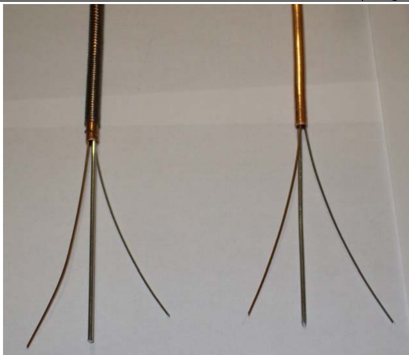
Fig. 3.5.5. Sârmele pline și sârma tubulară folosite la realizarea vergelelor și electrozilor.
