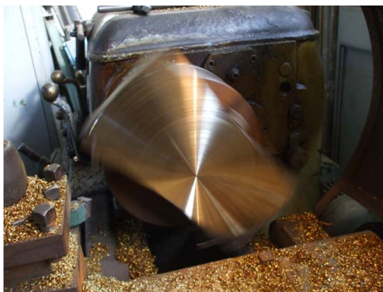
Fig. 3.2.2. Strunjirea plan paralelă a plăcilor din bronz.
