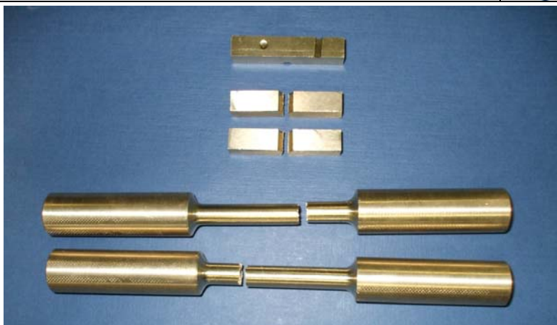
Fig. 3.6.2. Epruvete de încercare la tracțiune și reziliențe după realizarea încercărilor.
