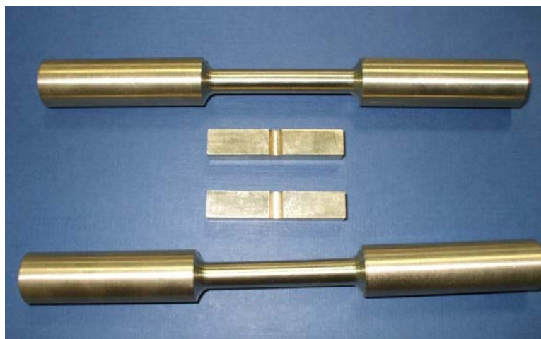
Fig. 3.6.1. Epruvete de încercare la tracțiune și reziliențe înainte de realizarea încercărilor.
