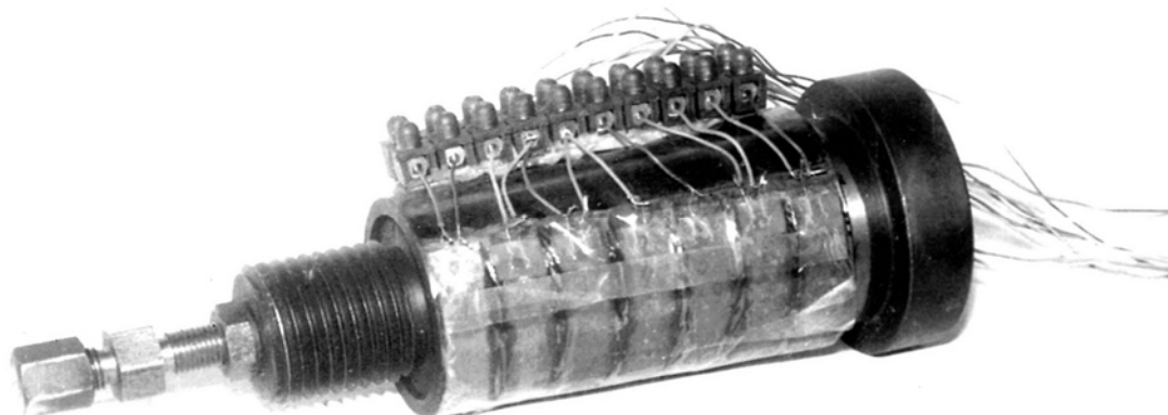
Fig.2.89. Montarea mărcilor tensometrice pe butuc pentru stabilirea distribuției de tensiuni.
