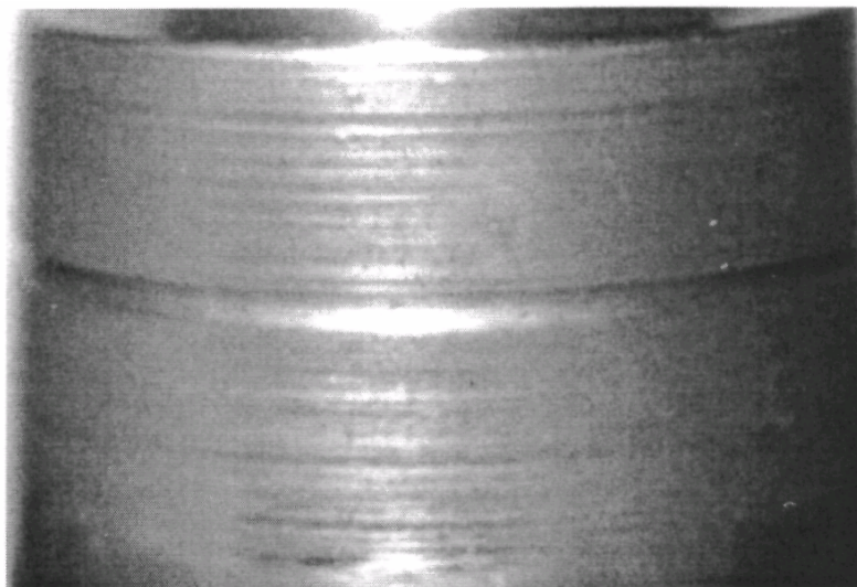
Fig.15 Amprenta circulară de fretting obținută în urma unor montări și demontări repetate a unei asamblări prin strângere.
