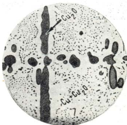
Fig. 2.25 Micrografia cuprului cu mai mult de 0.39% oxigen [31] (250:1)
