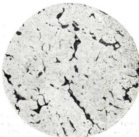
Fig. 2.19 Micrografia cuprului cu adaosuri de Pb (300:1) [31]
