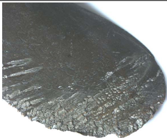
Fig.6 Uzură de cavitație cu o componentă corozivă, pe o pală de elice.
